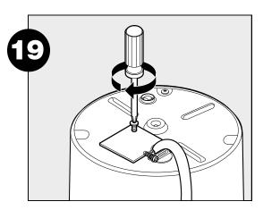
Pousser les fils dans le broyeur (ne pas déplacer l'écran de carton) et replacer la plaque électrique.
