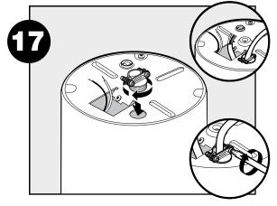
Couper l'alimentation électrique, insérer le connecteur de cable (non compris) et faire passer le câble électrique par le trou d'accès qui se trouve au bas du broyeur. Serrer le connecteur de câble.
