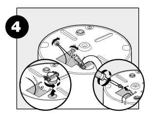
Couper l'alimentation électrique, puis déconnecter les fils du broyeur de l'alimentation électrique.
