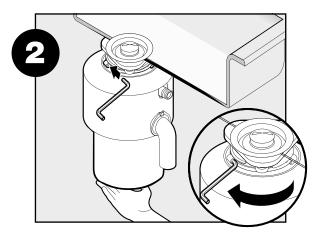
Soutenir le broyeur, insérer l'extrémité de la petite clé dans le côté droit de l'écrou de montage et tourner. Le broyeur chutera librement en place.
