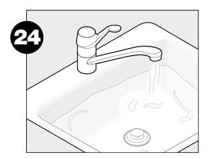
Mettre le bouchon dans l'ouverture de l'évier. Remplir e'évier d'eau pour vérifier qu'il ne fuit pas.
