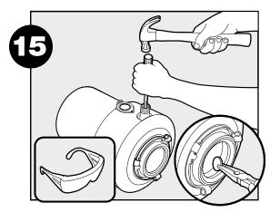
Faire tomber le bouchon du drain et enlever le bouchon qui se trouve à l'intérieur du broyeur.
