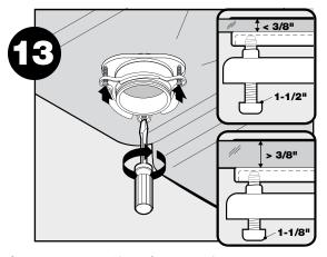
Serrer les vis uniformément et fermement contre la bride de retenue. Utiliser les vis plus courtes de 1-1/8 po si l'épaisseur de l'évier dépasse 3/8 pouce.
