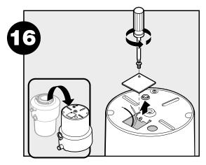
Renverser le broyeur et enlever la plaque électrique. Extraire les fils électriques. NE PAS ENLEVER L'ÉCRAN DE CARTON.
