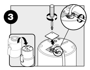
Couper l'alimentation électrique puis renverser le broyeur et enlever la plaque électrique. Conserver le connecteur de câble s'il y a lieu.
