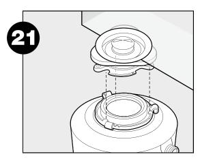
Accrocher le broyeur en alignant les 3 onglets de montage avec les glissières de l'anneau de montage.
