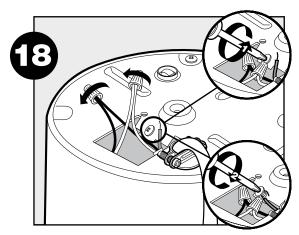
Connecter le fil blanc au fil blanc et le fil noir au fil noir ou rouge au moyen de serre-fils (non compris); mettre le fil à la terre au moyen de la vis verte de mise à la terre. L'unité doit être mise à la terre pour assurer une installation adéquate et sûre.
