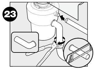
Le tuyau devra peut-être être coupé pour s'ajuster proprement. Reconnecter la tuyauterie (et le lave-vaisselle ou la prise d'eau directe le cas échéant). S'assurer que le raccord de vidange est droit.
