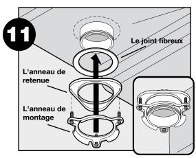
Insérer le joint fibreux, l'anneau de retenue et l'anneau de montage. Tenir le tout en place pendant l'insertion du jonc de blocage.
