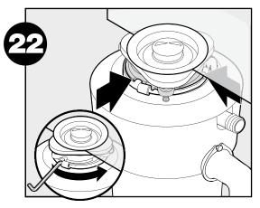
Faire tourner l'anneau de montage jusqu'à ce que les 3 onglets se bloquent par-dessus les nervures des glissières.
