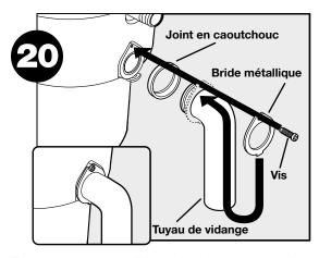
Tourner le broyeur. Placer le joint en caoutchouc à l'extrémité du tube de décharge et le glisser sur la bride métallique par l'autre extrémité. Placer le tube de décharge assemblé dans l'ouverture du raccord droit de vidange et fixer avec la vis fournie.
