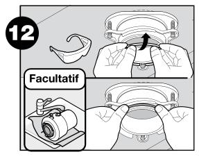
Placer un poids tel que le broyeur sur le collet de l'évier pour le maintenir en place. Utiliser une serviette pour éviter d'égratigner l'évier. Ouvrir le jonc de blocage et appuyer fermement jusqu'à ce qu'il s'enclenche.
